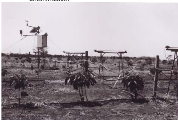
Figura 8 a e b – Vista da disposição dos tubos solarímetros (TS-UM-3, Eijkelkamp) e da estação micrometeorológica (Delta-T Devices Inc.) no campo experimental – Piracicaba-SP.
