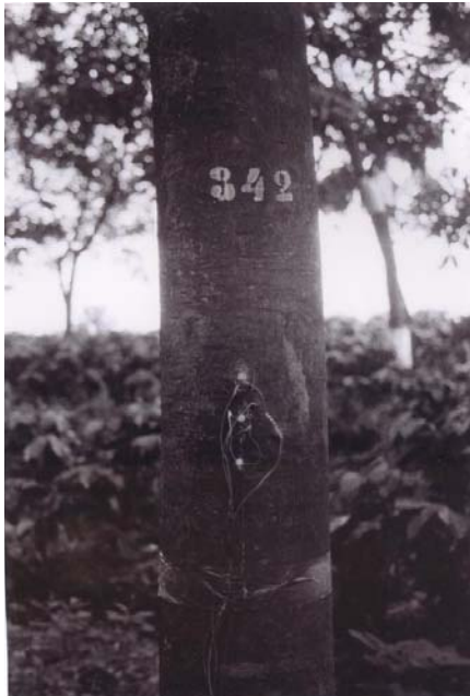
Figura 5a - Visualização do sensor de fluxo de seiva do método da sonda de Calor – Método de Granier de construção própria em seringueira do experimento.
