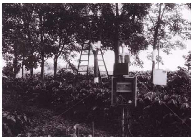
Figura 9 – Vista parcial do interior do seringal onde podemos observar as árvores com os sensores de fluxos de seiva do Método de Granier e o data-logger (Delta-T Devices Inc.) utilizado na coleta de seus dados. Observar árvore ao fundo com sensores tanto em seu tronco como nos dois ramos em que se subdivide para verificação de seu funcionamento.
