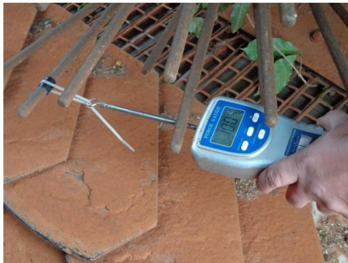
Figura 6 Dinamômetro portátil que foi utilizado para quantificar as forças necessárias para o início do giro do cilindro
