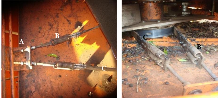
Figura 4 Sistema de freio (A) Parafusos, (B) Molas e (C) Cinta de freio
