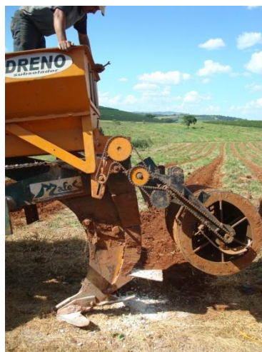
Imagem1. Dreno e batedor de covas utilizados no experimento de Eloi Mendes, MG.
