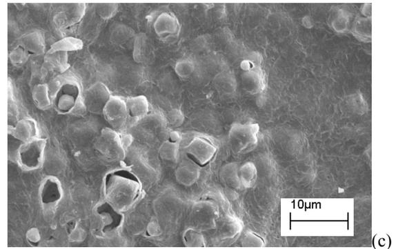
**Figura 1.** Fotomicrografias da morfologia do PHB-HV e dos compósitos PHB-HV/ casca e PHB-HV/ polpa.
