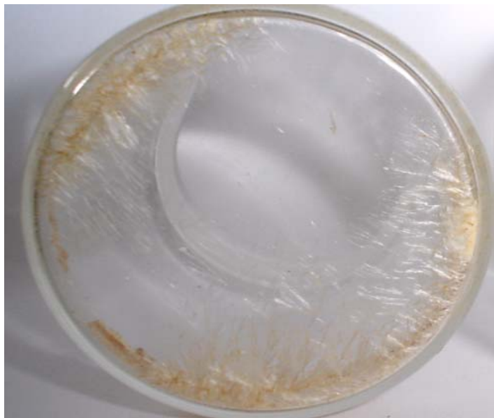
Figura 6.20 - Amostra de cafeína purificada de 5 gramas de casca, com um volume de hidróxido de potássio de 5 mL e um tempo de agitação de 10 minutos.
