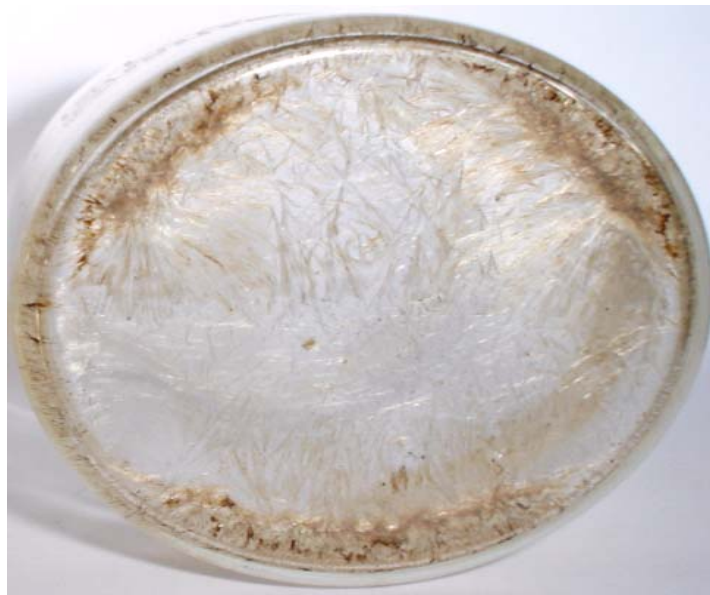
Figura 6.13 – Amostra de caféina purificada com uma massa de carvão ativado de 0,03 gramas e um tempo de agitação de 10 minutos.
