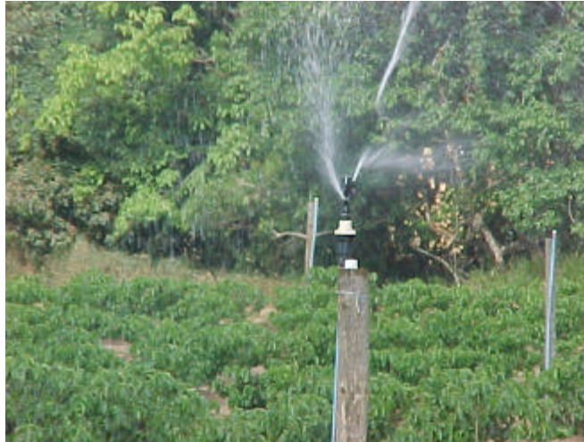
Figura 8- Detalhe do aspersor em funcionamento em sistema de irrigação do tipo malha.
