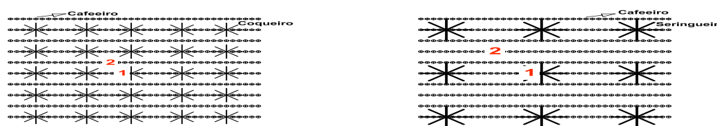
Figura 1. - Representação esquemática da posição de instalação de sensores (ponto 1 linha e ponto 2 entre-linha) na parcela consorciada com coqueiro-anão verde (esquerda) e seringueira (direita).
