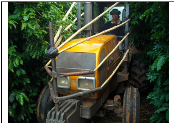
Detalhe da armadura adaptada a um trator cafeeiro, vendo-se a parte frontal ,de canos de ferro, que desvia os ramos, e onde se adaptam bambus, para completar o deslize e desvio
