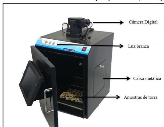
Figura 2. Sistema de aquisição de imagens desenvolvido para classificação de grãos de café torrados inteiros e moídos
