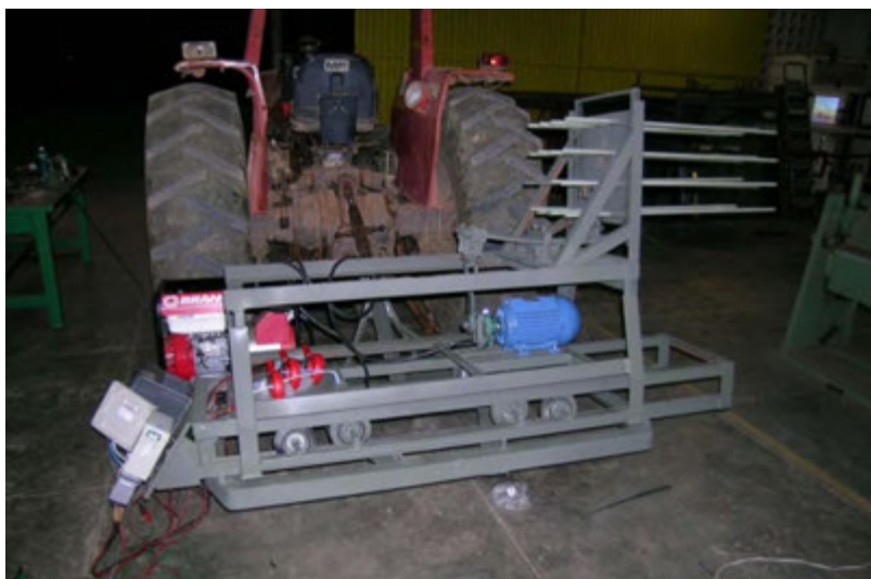
Figura 4.1 - Dispositivo de derrixa por vibração.
