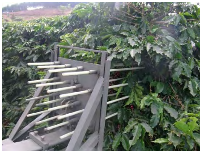
Figura 4.2 - Posicionamento das hastes no dossel do cafeeiro.
