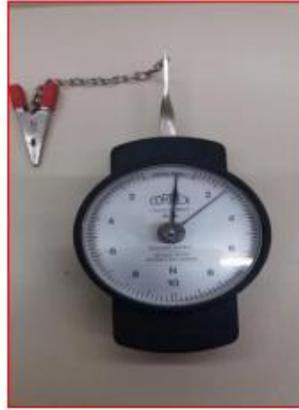
**Figura 1-** medindo a força de desprendimento dos frutos de café com o equipamento dinamômetro mecânico modelo Correx- Haag e Streit.
