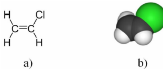
Figura 4. Representação do monômero do PVC (a) estrutura molecular e b) estrutura tridimensional.
