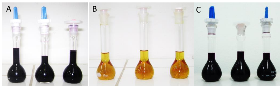
Figura 16. A) Ensaio do DPPH puro; B) Ensaio do BHT e DPPH; C) Ensaio do OBC e DPPH
