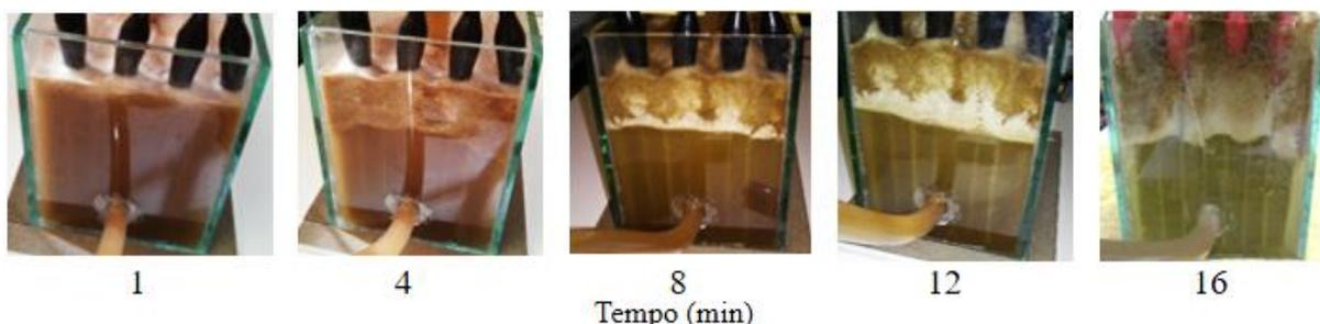
Figura 4. Aspecto do efluente no reator durante um experimento nas condições avaliadas para o tratamento da água residuária do café sem recirculação (ARC1). Fonte: O autor.
