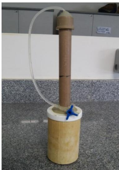
**Figura 4.** Extrator de cápsula porosa utilizado no experimento.
