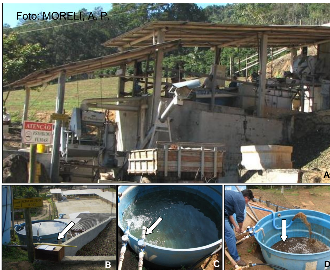
Figura 1 - Vista dos equipamentos da unidade de processamento dos frutos do cafeeiro. Fazenda Experimental de Venda Nova do Imigrante-ES, 2010: A – Lavador separador; Abanador; Descascador; Rosca elevatória de casca; Tanque de degomagem; B – Moega; Medida padrão de café (40L); Caixa de água limpa; C – Hidrômetros; D – Reservatório de água residuária.
